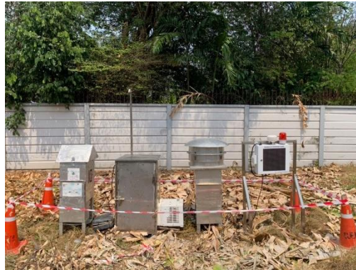
รูปที่ 3.2 การเก็บตัวอย่างคุณภาพอากาศในบรรยากาศ จุดที่ 1 บริเวณพื้นที่รื้อถอน (บริเวณด้านทิศเหนือก่อนแนวรั้วโครงการ) และตรวจวัดด้วยเครื่องตรวจวัดแบบอ่านค่าทันที (Real time monitoring device)
