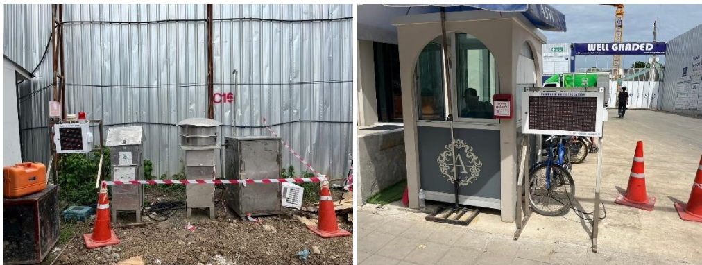
รูปที่ 3.19 การเก็บตัวอย่างคุณภาพอากาศในบรรยากาศ จุดที่ 1 บริเวณภายในพื้นที่โครงการบริเวณด้านทิศเหนือก่อนแนวรั้วโครงการ และตรวจวัดด้วยเครื่องตรวจวัดแบบอ่านค่าทันที (Real time monitoring device)
