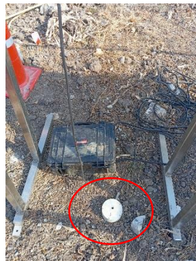
รูปที่ 3.17 การตรวจวัดความสั่นสะเทือน บริเวณพื้นที่รื้อถอน (บริเวณด้านทิศเหนือก่อนแนวรั้วโครงการ)
